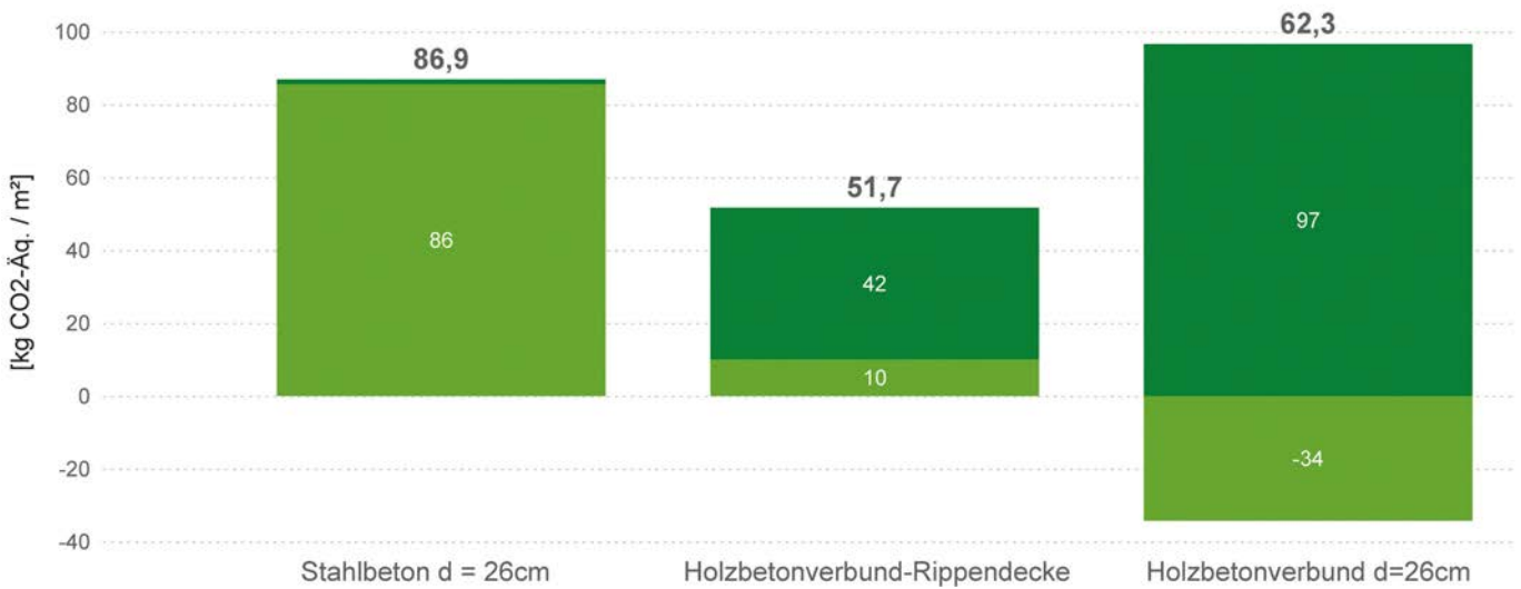
Bild 3 Vergleich Decken CO 2 -Äq./m²: Stahlbeton, Holzbetonverbund-Rippendecke, Holzbetonverbunddecke (Quelle: B+G) Comparison of slabs CO 2 e/m²: reinforced concrete, timber-concrete composite rib slab, timber-concrete composite slab
